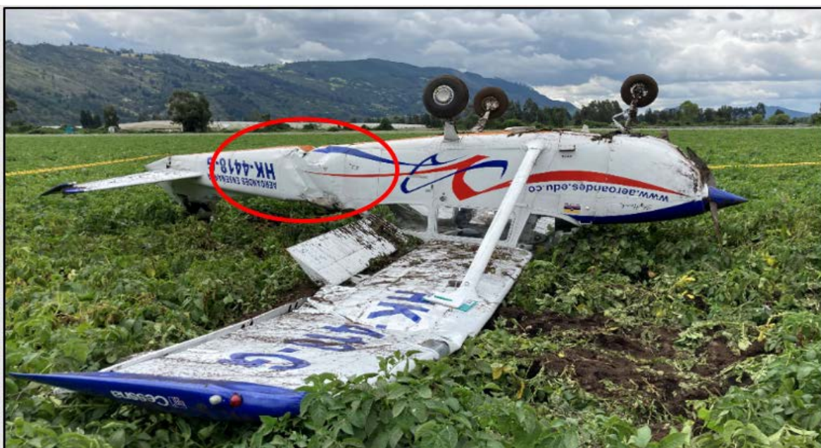
Fotografía No. 2: Daños sustanciales en la parte posterior del fuselaje.
