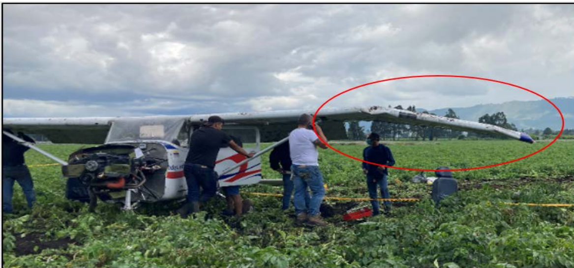
Fotografía No. 4: Daños en el plano izquierdo.
