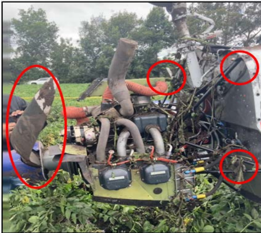
Fotografía No. 3: Daños en la hélice del motor y en los acoples a la bancada.
