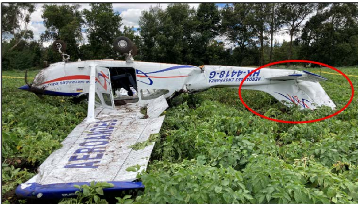
Fotografía No. 5: Daños del estabilizador vertical.
